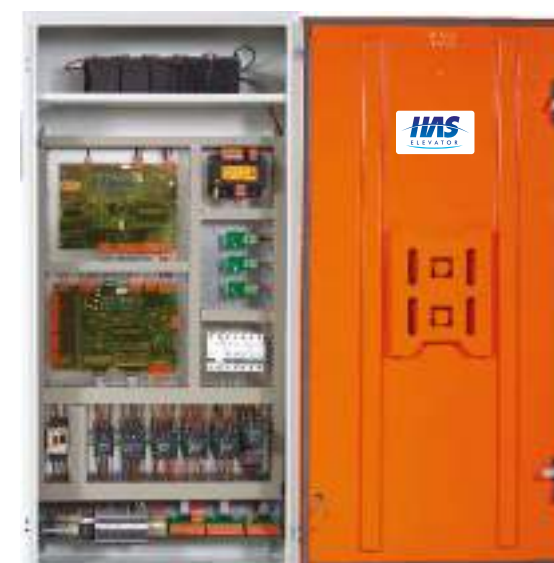
2-х скоростная станция управления
